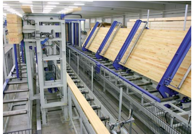
Paternosterstapelung zur Beschickung einer vertikalen Hydraulikpresse
