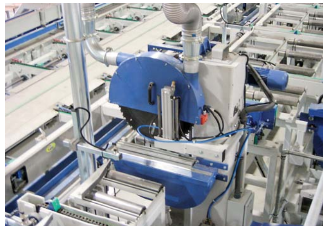
Ablängsäge für Bauteilbreiten bis 250 mm
